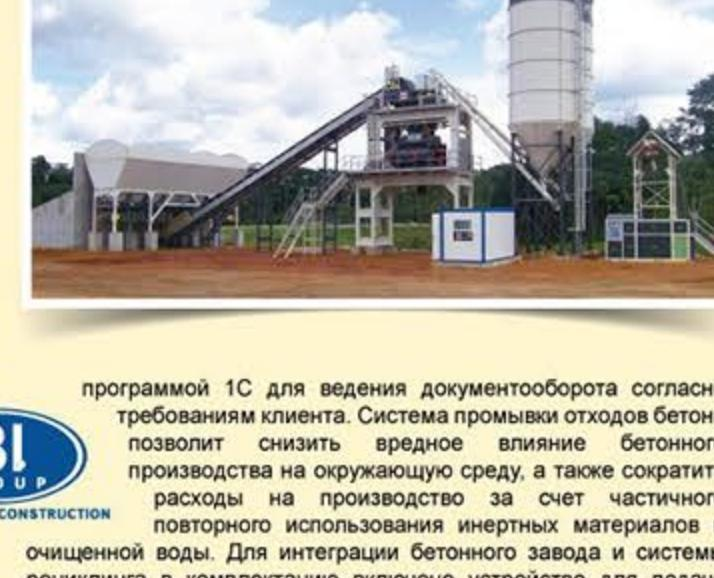
программой 1С для ведения документооборота согласно требованиям клиента. Система промывки отходов бетона позволит снизить вредное влияние бетонного производства на окружающую среду, а также сократить расходы на производство за счет частичного повторного использования инертных материалов и очищенной воды. Для интеграции бетонного завода и системы рециклиг в комплектацию включено устройство для подачи воды от бетонного завода к установке, а также дозатор шламовой воды на самом заводе.
